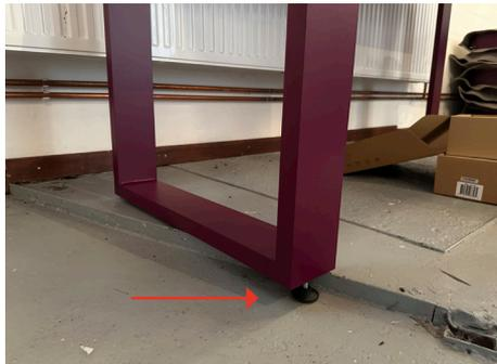
Unebenheiten des Fußbodens mittels höhenverstellbarer Schraubfüße ausgleichen.
